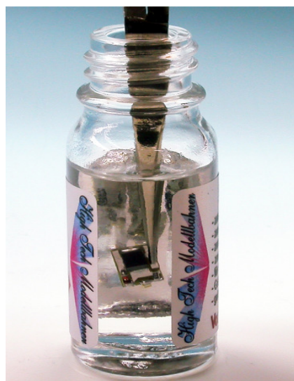
Bild 2: So wird ein Baustein abgewaschen
